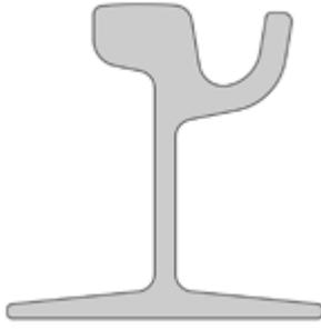
Abb. 15 Querschnitt Rillenschiene
