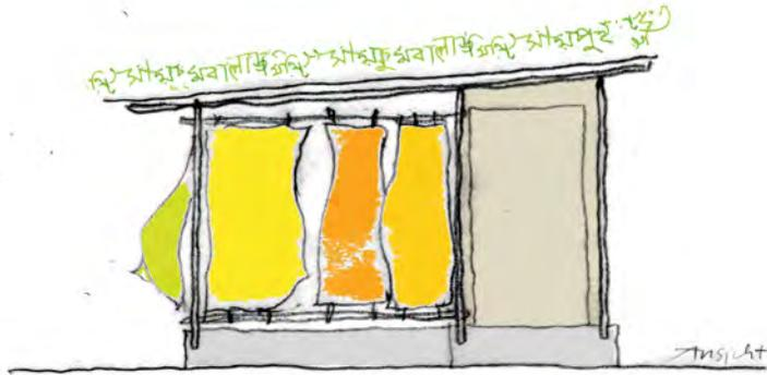
3. Phase. bei Bedarf an Werkstätten: eine Betonplattform wird gegossen, deren Größe sich nach dem jeweiligen Platzbedarf richtet; anstelle der Kletterpflanzen wird eine Lehmputzschicht auf das Bambusgerüst aufgetragen. Zwei zusätzliche Bambusstützen und ein Dach bilden eine schattige Arbeitsfläche, die Fassadengestaltung liegt in der Hand der Nutzer (links: z.B. Schneiderei)
