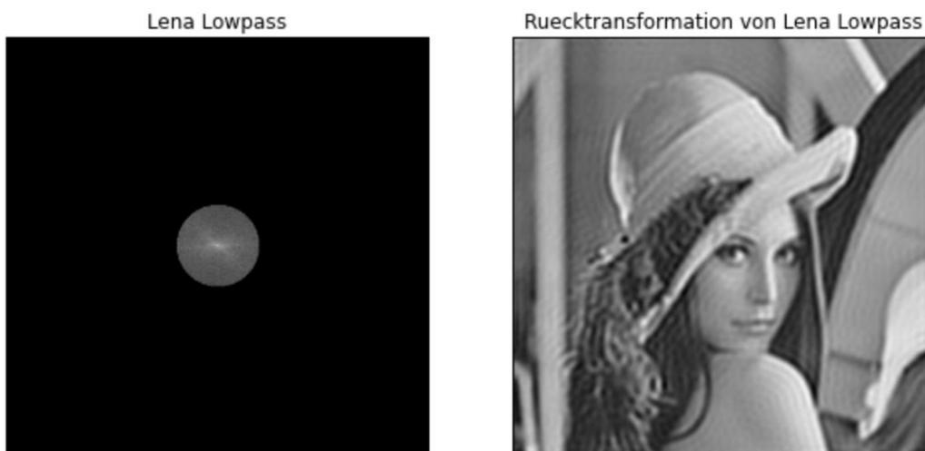
Abb. 30: Tiefpassfilter und Rücktransformation
