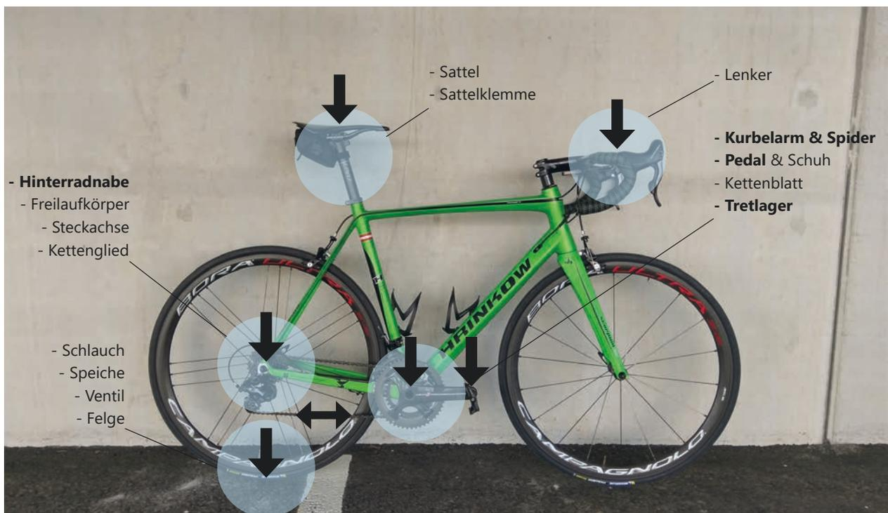
Abb. 125: mögliche Positionen für einen Powermeter am Fahrrad (Schaden-Handstanger, P., 2022)
