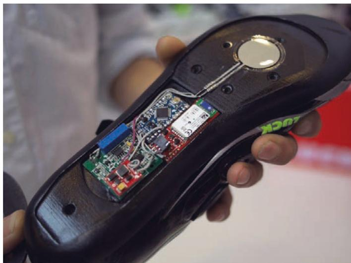
Abb. 59: Schuhsohle mit Elektronik Luck Racer 3.0
