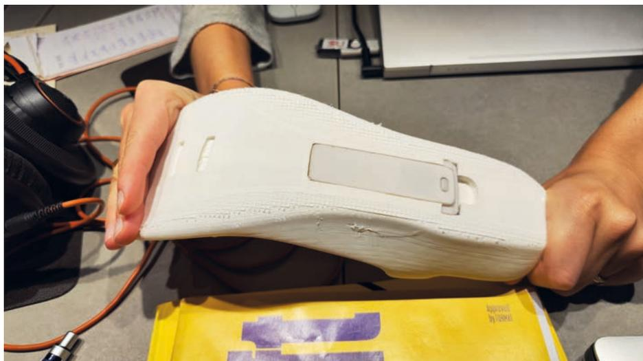
Abb. 170: Sohle inklusive Elektronikeinheit (Schaden-Handstanger, P., 2022)
