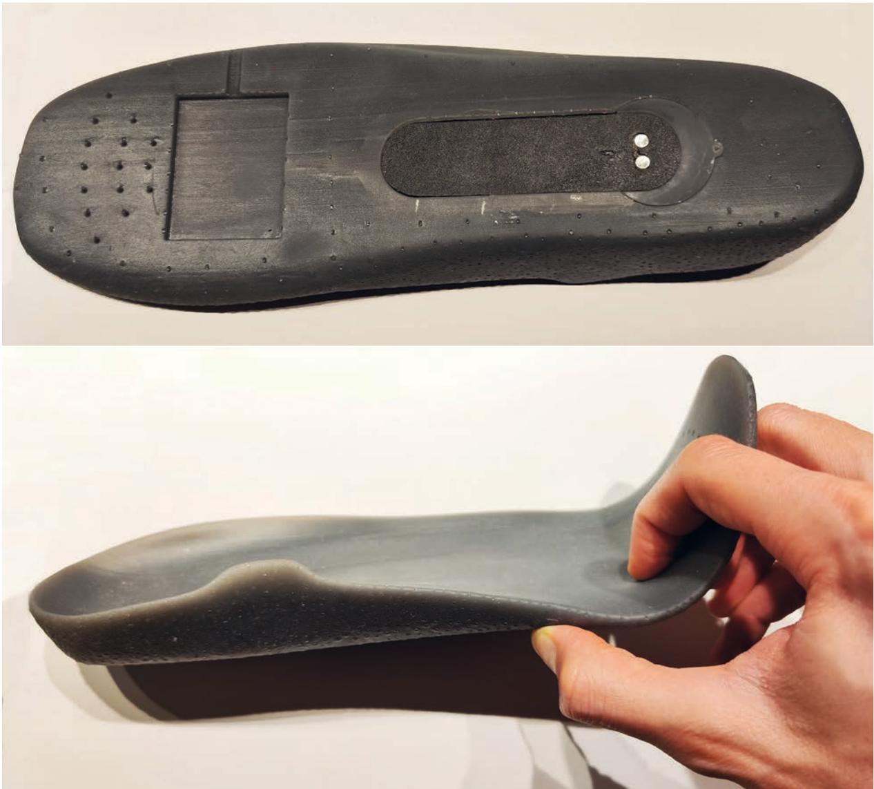
Abb. 175: DLP-Druck Sohle (Schaden-Handstanger, P., 2022)
