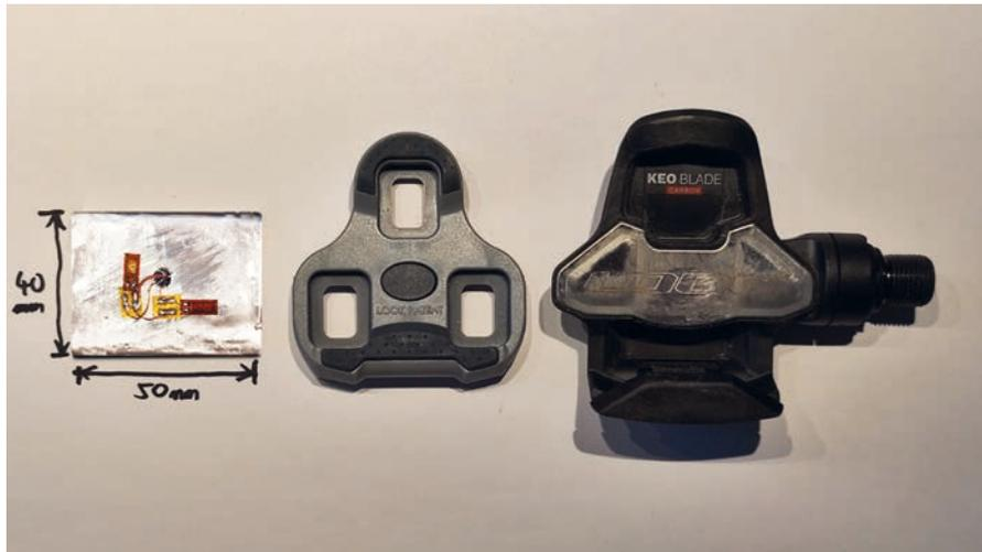
Abb. 180: Größenvergleich der Aluminium-Messplatte (Schaden-Handstanger, P., 2022)
