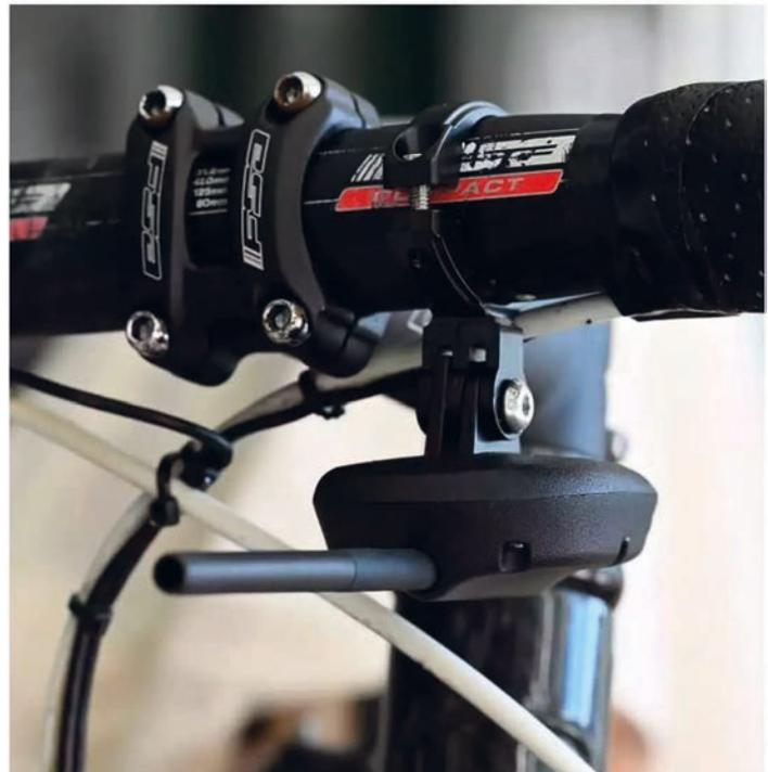
Abb. 47: Lenkermontage Velocomp PowerPod
