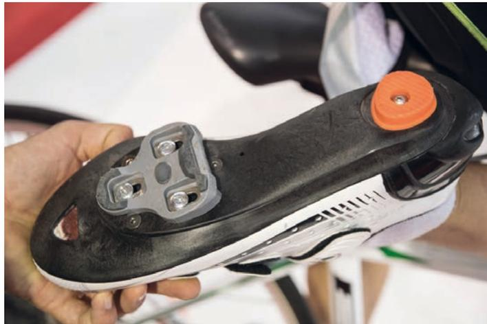
Abb. 58: Powermeter-Schuh Luck Racer 3.0
