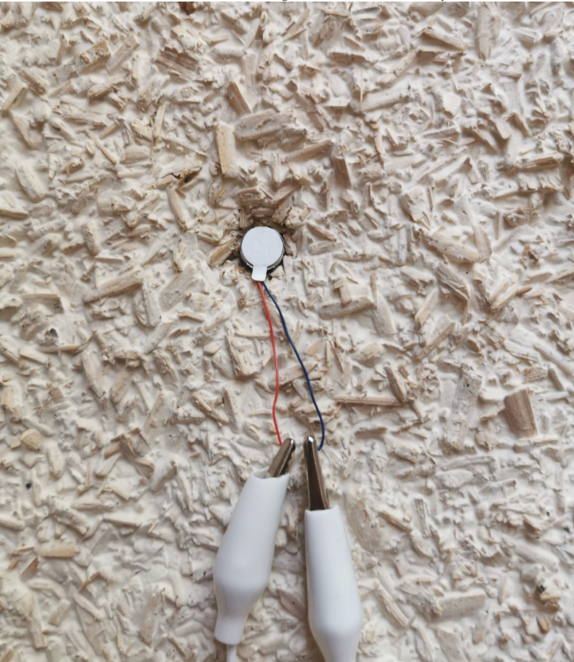
Fig. 37 Mini vibration motor in mycelium
