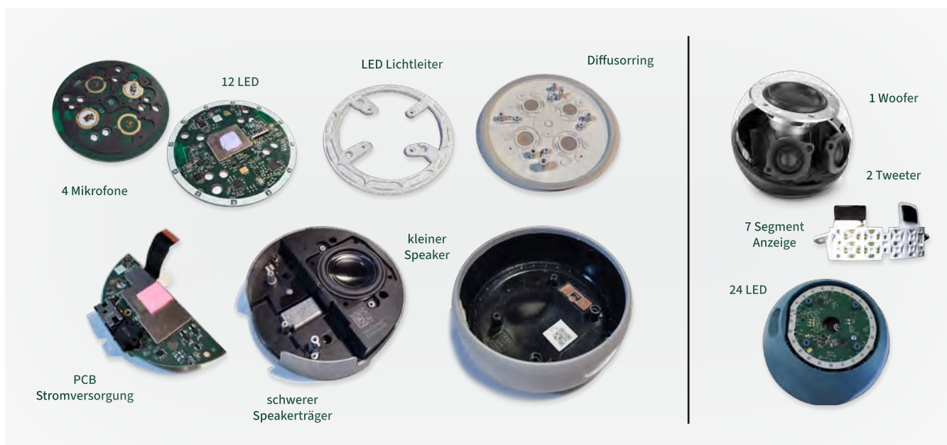
Abb. 65: Technische Analyse von Amazon Echo 2. Generation (links) und des Echo der 5. Generation (rechts)
