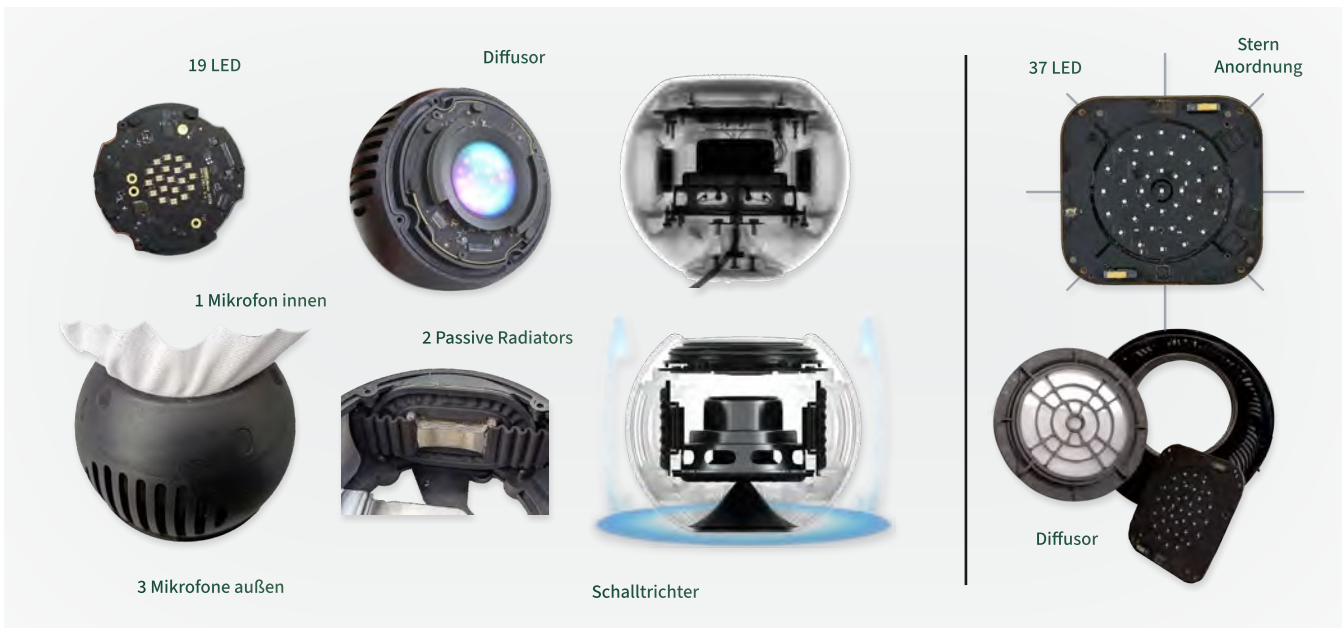
Abb. 66: Technische Analyse des Apple HomePod mini (links) und des HomePod 2. Generation (rechts) (Dixon, 2021)
