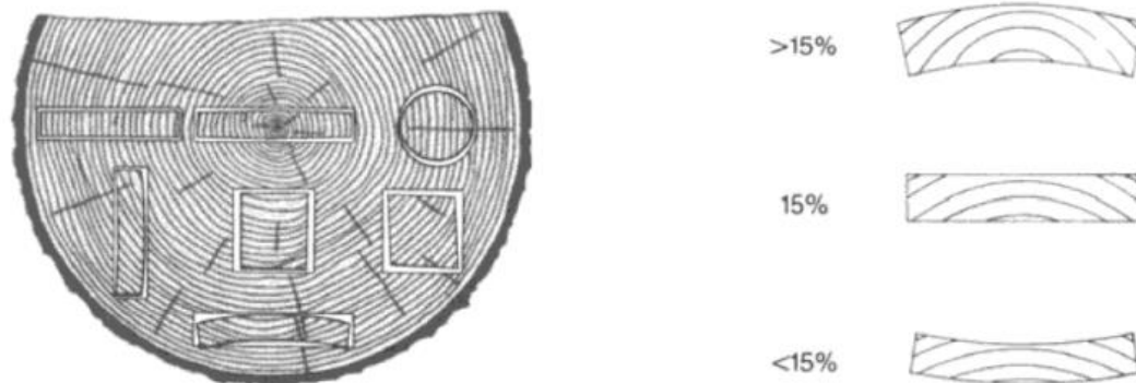
Abbildung 6: Quellen und Schwinden verschiedener Querschnittslagen[9]
