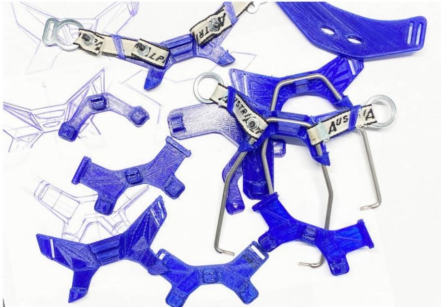
Abbildung 96: Entwicklungsprozess des hinteren Korbchens
