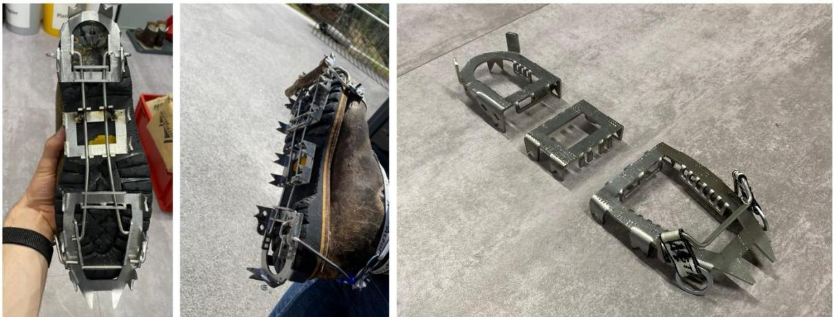
Abbildung 89: Prototypen des Steigeisenrahmens
