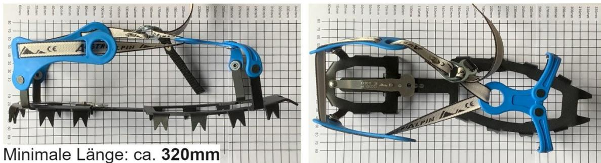
Abbildung 5: Minimale Länge der Steigeisen
