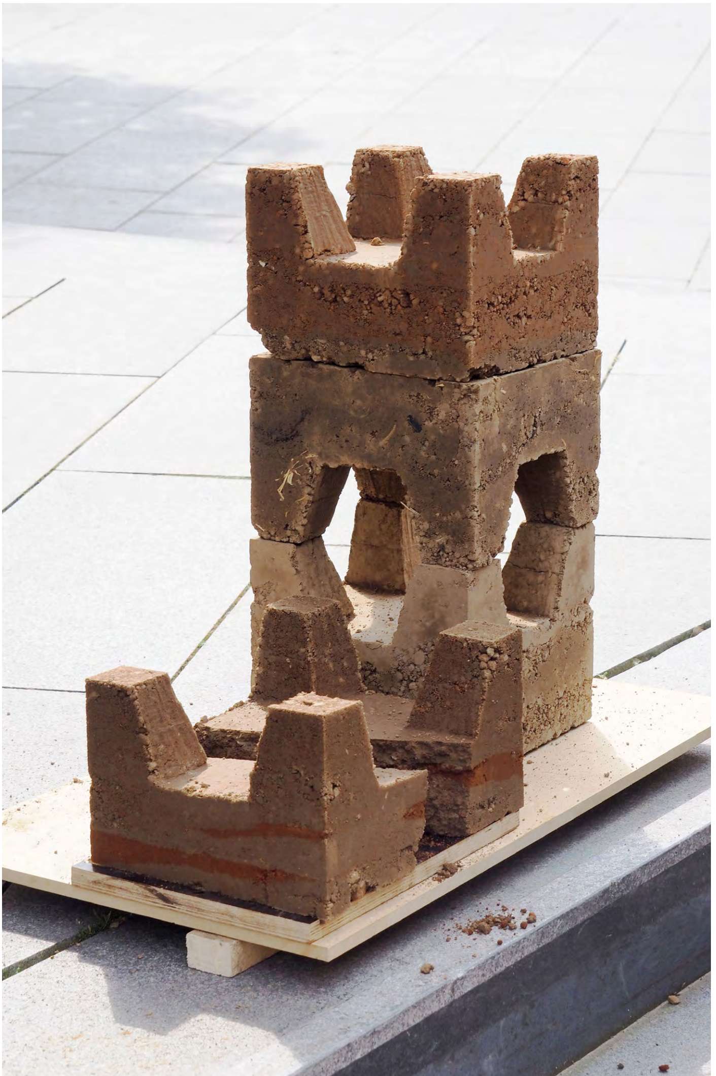
Abb. 49: Stampfhelemente Workshop Uni Kassel.
