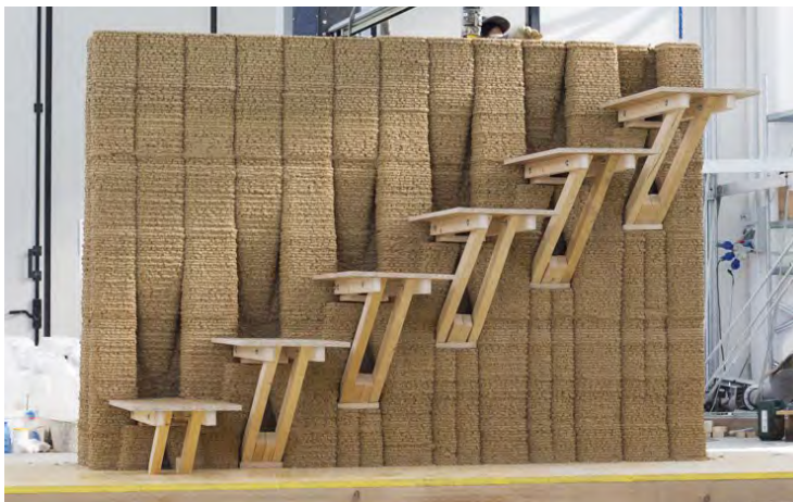
Abb. 197: Treppenstufen aus Lehm mit 3D Drucker hergestellt
