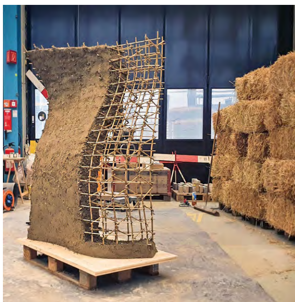
Abb. 212: Struktur mit Lehm-Stroh Mischung
