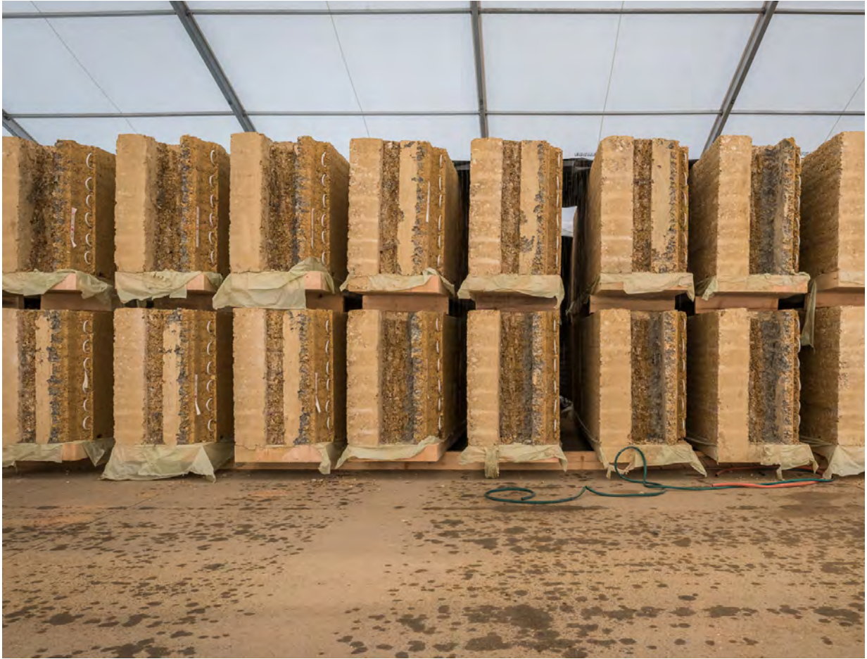
Abb. 14: Lagerung der vorgefertigten Stampflehmelemente
