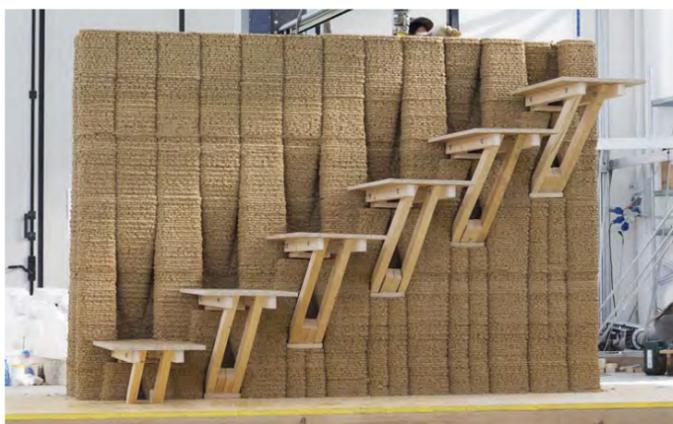
Abb. 197: Treppenstufen aus Lehm mit 3D Drucker hergestellt
