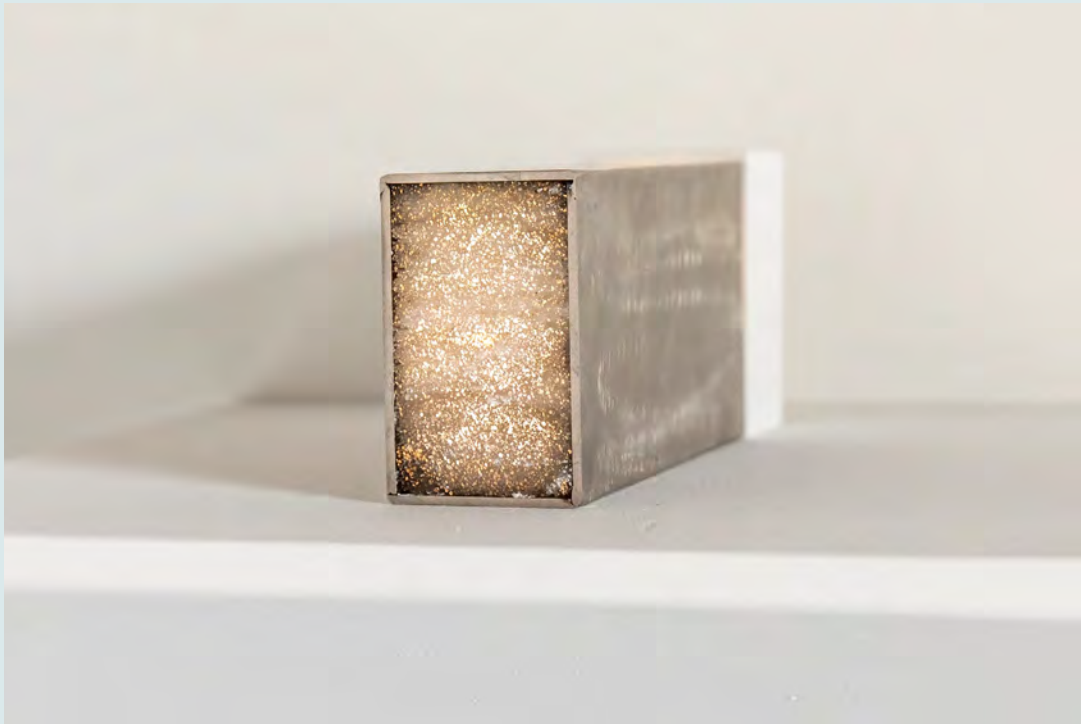
Abb. 221 | Transluzenter Beton nutzt das Prinzip der Nano-Optik, bei dem optische Glasfasern das Licht durch das Material leiten. Diese Fasern sind gleichmässig im Beton verteilt und auf beiden Seiten sichtbar. Áron Losonczy, 2001, LiTraCon . Abb. 222 | Handgemachter Ziegelstein aus Glasfasern und Stahl, 9,2 \times 5,7 \times 19,4 cm. Helen Lee, 2018, Incoherent Brick .
