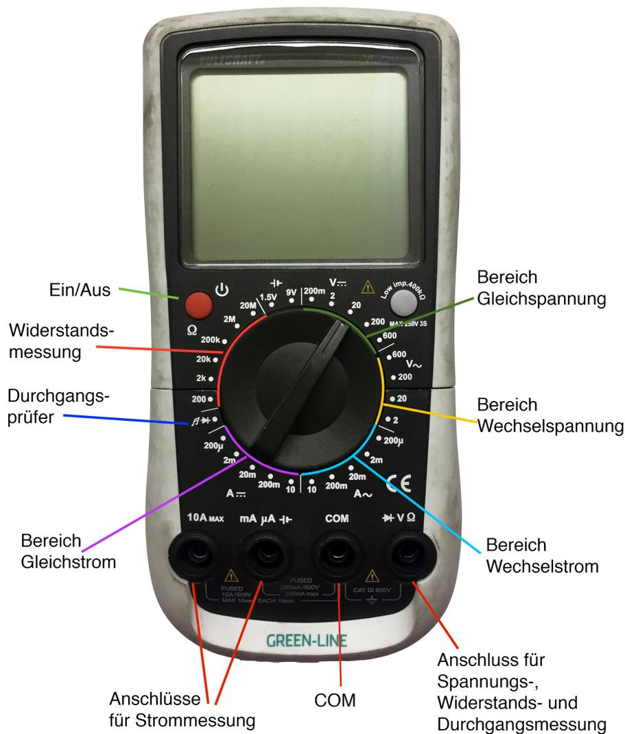
Abb. 15: Digitalmultimeter Messbereiche und Anschlüsse
