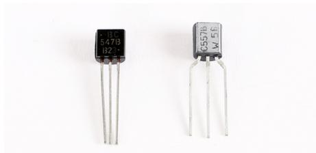
Abb. 55: verschiedene Transistoren
