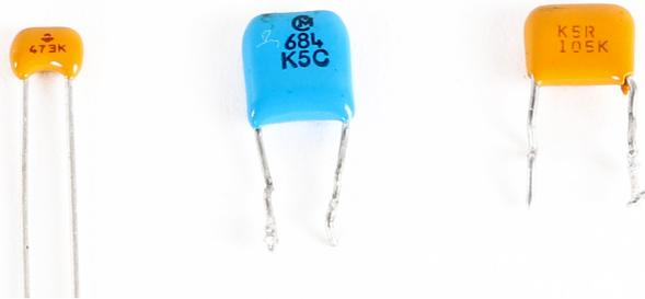
Abb. 40: ungepolte Kondensatoren
